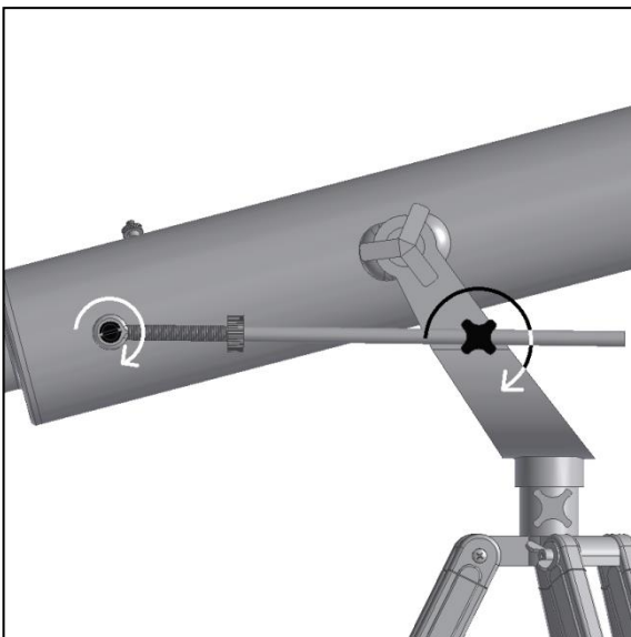
Figure 7. Tige de mise au point précise en place.
